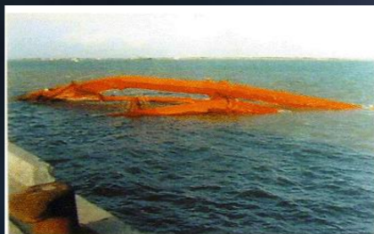
1996年9月,受9615号台风影响,湛江港500多吨重的集装箱装卸桥吊被抓入大海
